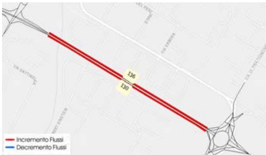
Figura 107 – Scenario di Intervento di Breve Periodo – Venerdì – Variazione flussi rispetto a Scenario Attuale
