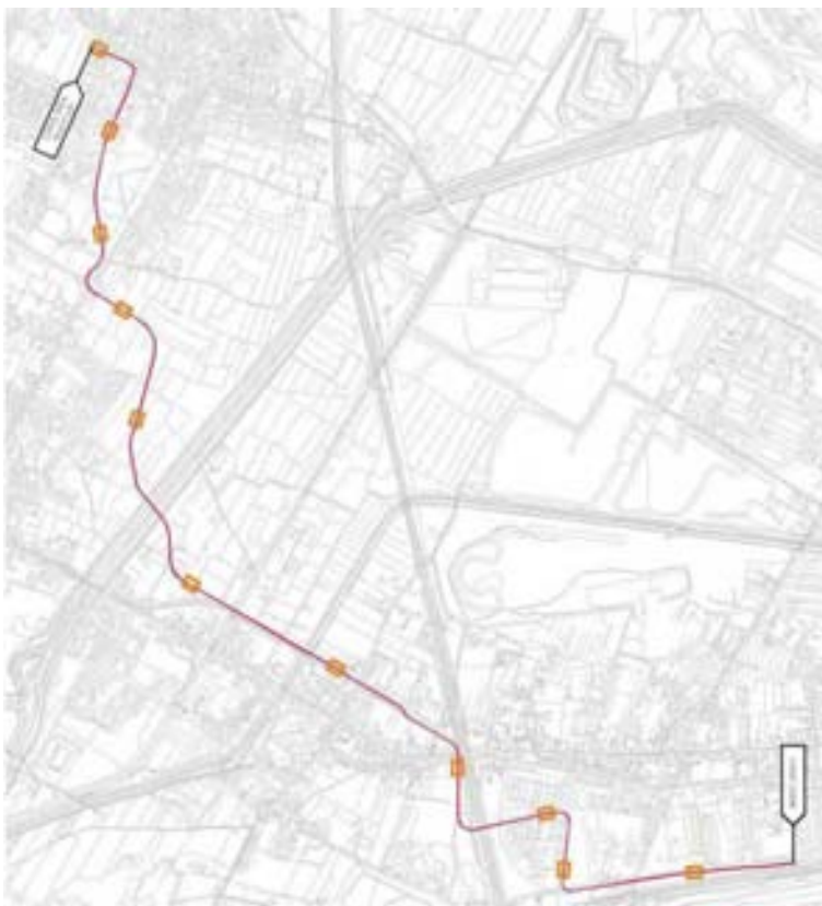
Figura 12 – Planimetria del tracciato Linea 4.2 e fermate di progetto – Fonte: “Progetto di Fattibilità Tecnica ed Economica per l'estensione del Sistema Tramviario Fiorentino nei Comuni di Firenze, Campi Bisenzio e Sesto Fiorentino – Fase C”
