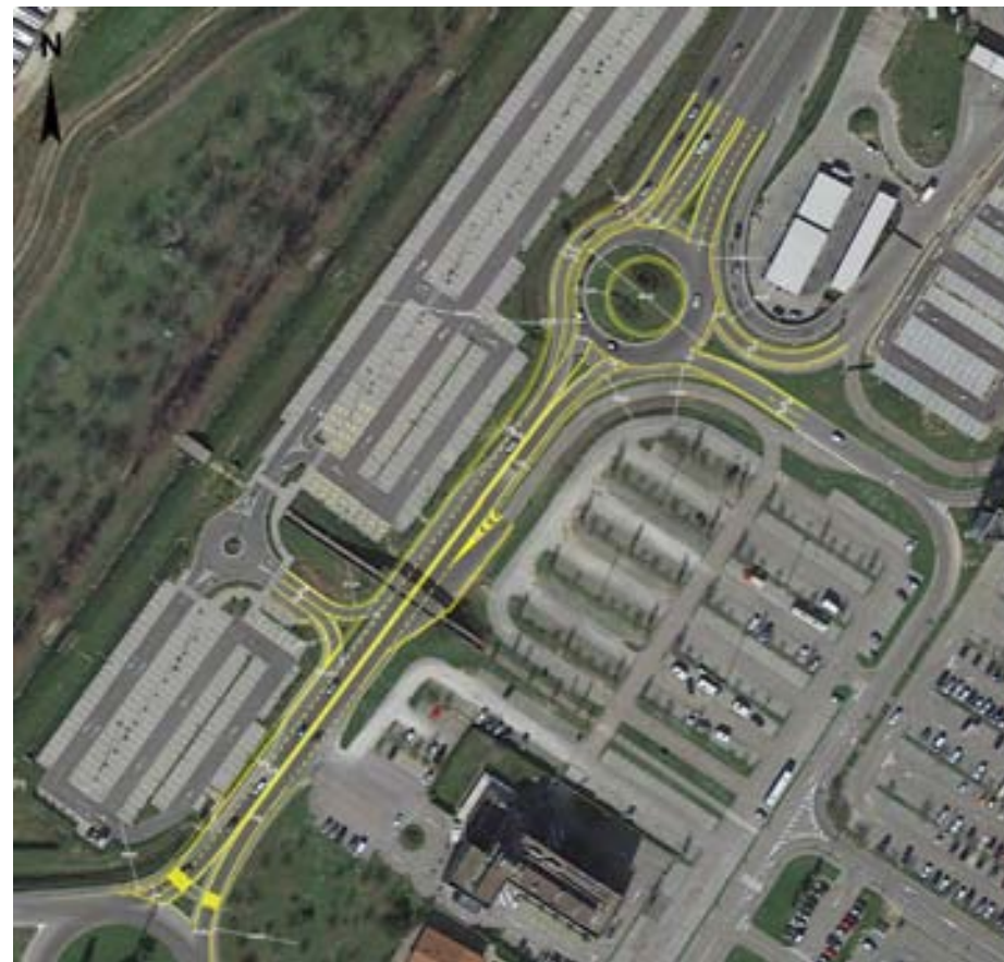
Figura 61 – Scenario di Intervento – Sovrapposizione su ortofoto della rotatoria via Parco Marinella-accesso CC "I Gigli"
