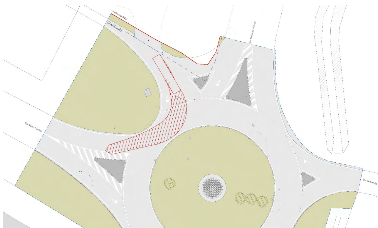
Fig. 2.4.13 – Verifica ingombri dinamici autoarticolato in uscita
